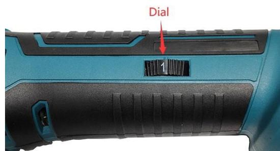
振動するスピードを調整することができます。ダイヤルを回して1～6まで変更できます。ダイヤルの数字が大きくなるほどスピードが早くなります。
