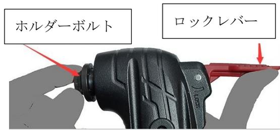
① ロックレバーを全開にし、ホルダーボルトを反時計回りにねじって外します。
