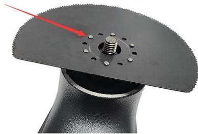
② ツールフランジの突起部分が刃の穴に合うようにセットします。
