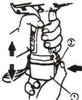
バッテリーを取り外すときは、ハンドル部分をしっかりと握った状態でバッテリーの留め具(②)を押して、バッテリーを下方向に引きます。
